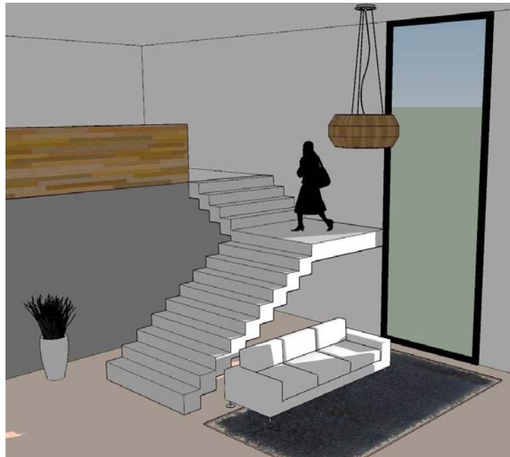
Figura 3- Exemplo de escada não enclausurada, sem Isolamento e integrada ao ambiente.
