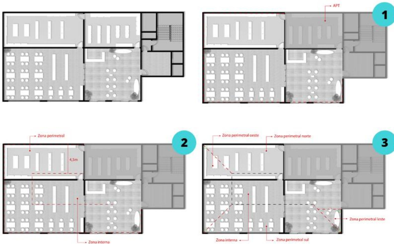
Figura 14 – Passo a passo de divisão das zonas térmicas do pavimento 1
